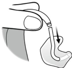
Desconecte el tubo y el molde del codo. Sostenga firmemente el codo al extraer el tubo. De lo contrario, puede dañar el audífono.
