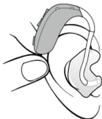
Tire suavemente de la oreja hacia fuera y presione el molde hacia el interior del conducto auditivo girándolo lentamente.
