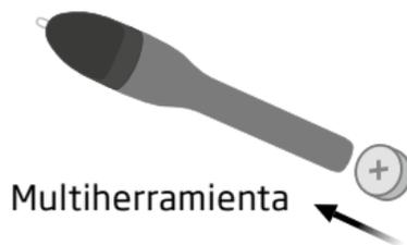
Puede usar la multiherramienta para cambiar la batería. Utilice el extremo magnético para extraer e insertar las pilas.
